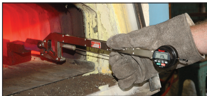
Pinza calibradora para aceros el rojo vivo.
